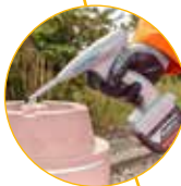
i+ignite : allumage facile de la charge pour initier le processus de la soudure
