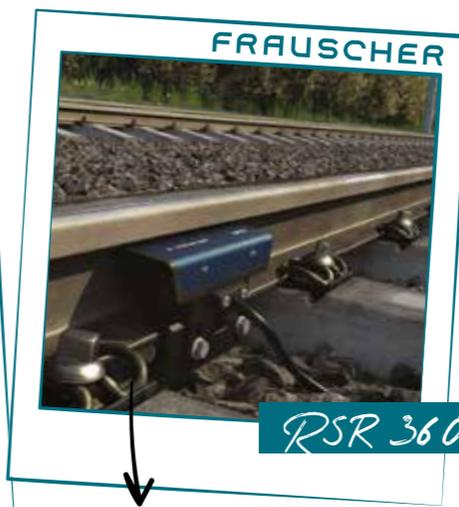
La **RSR360** est un nouveau capteur de roue qui améliore la détection des trains en renforçant sécurité, fiabilité et efficacité. Avec une haute sensibilité, une meilleure résistance aux interférences et aux conditions difficiles, il est compatible avec plus d'équipements de maintenance et technologies de freinage. Il inclura une interface Ethernet pour des réseaux évolutifs et l'intégration avec d'autres capteurs pour surveiller l'état des voies.
