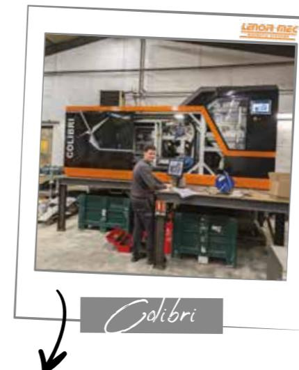
**Colibri** est un séparateur magnétique pour le recyclage, utilisant des courants de Foucault à très haute fréquence pour extraire les métaux non-ferreux. Il n'utilise pas d'aimants permanents, réduisant ainsi les contraintes liées aux prix et à la disponibilité des matériaux. Conçu à partir de métaux recyclables, il améliore la qualité du tri et réduit l'empreinte carbone.
