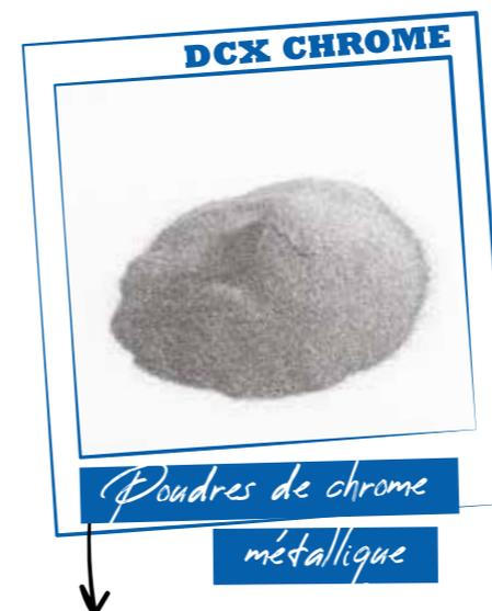
Les **poudres de chrome métallique** sont produites pour les interconnexions des piles à combustible à oxyde solide (SOFC) et pour des applications futures dans les électrolyseurs et la production d'électricité marine. DCX Chrome garantit une composition chimique et une granulométrie optimales, essentielles à la performance des équipements de production d'énergie utilisant ces poudres.
